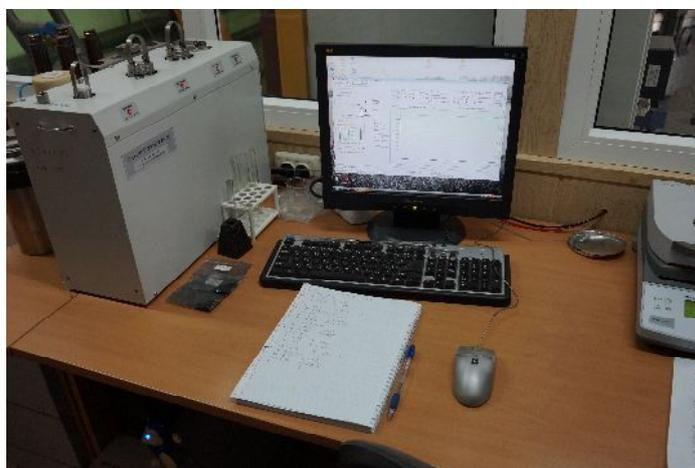
Рисунок 4 – Сорбтометр - М
