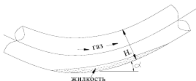
Рисунок 1 - Пониженный участок газопровода с жидкостным скоплением
