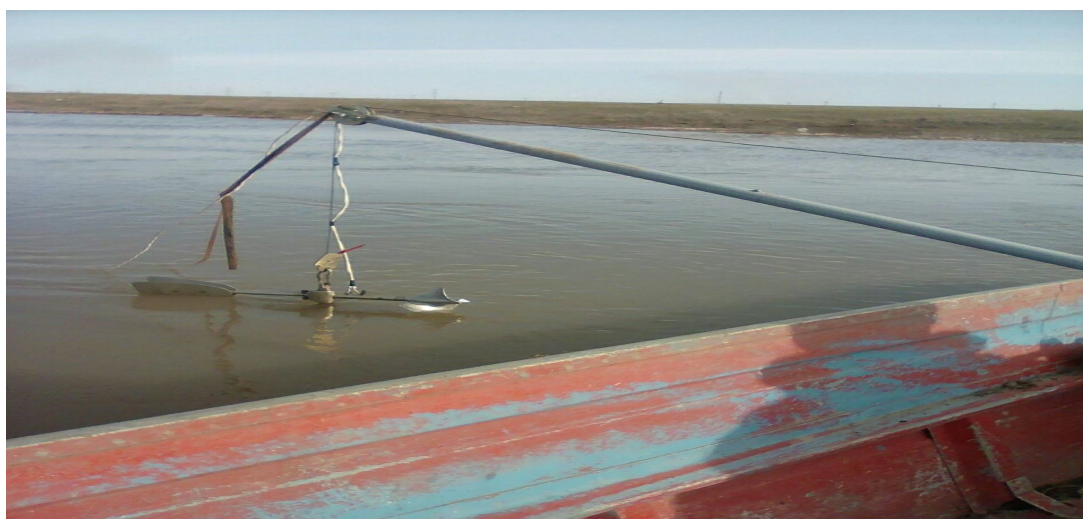
Рисунок 2– Измерение скорости течения в реке Урал гидрометрической вертушкой
