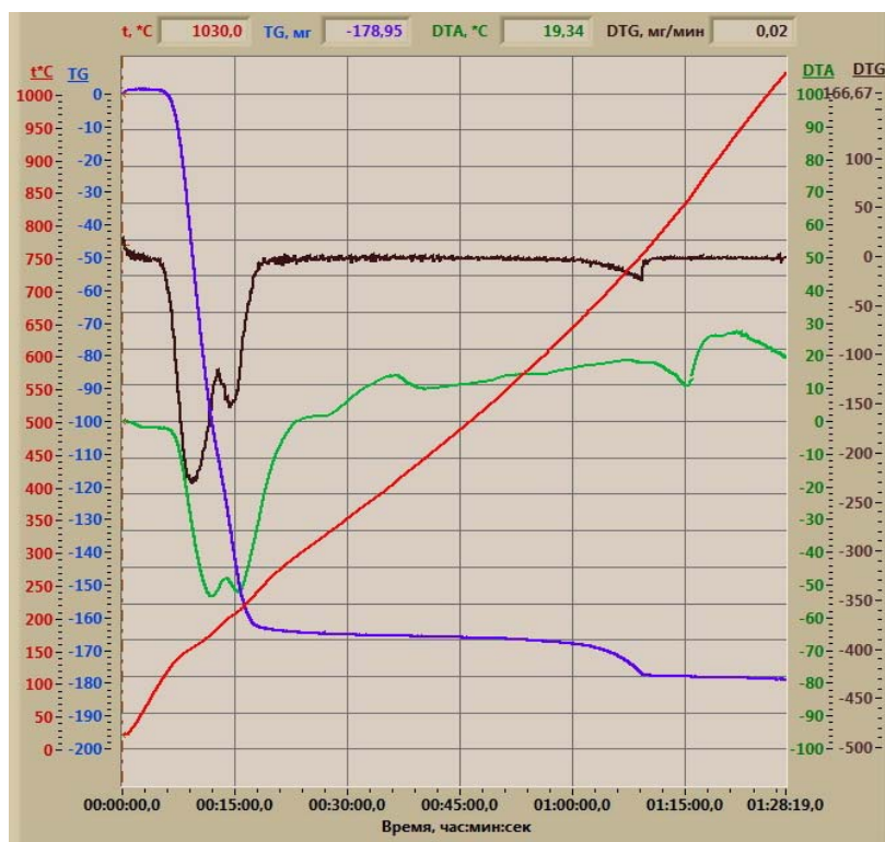
Рисунок 1 – Кривая ДТА образца гипсового камня
