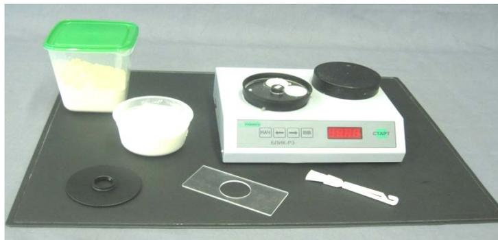
Рисунок 1 – Прибор «Белизномер Блик Р3» для определения белизны пшеничной и ржаной муки
