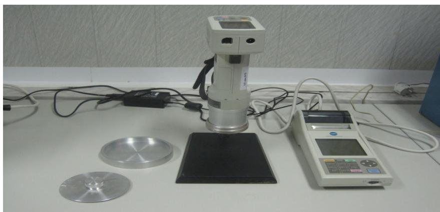
Рисунок 2 – Прибор для определения цветовых характеристик муки «Chroma meter CR-410» - фирма «Konica Minolta» - Япония
