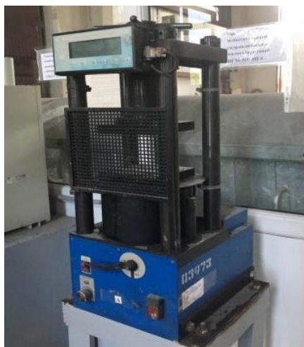
3 сурет - ПГМ-500 МГ4 гидравликалық сынақ прессі
