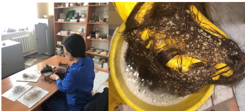
2 сурет - Талшықтарды тазарту және сабын-сода ерітіндісінде жуу процесі
