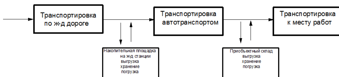
Рисунок 1 – Технологическая схема транспортировки строительных материалов
