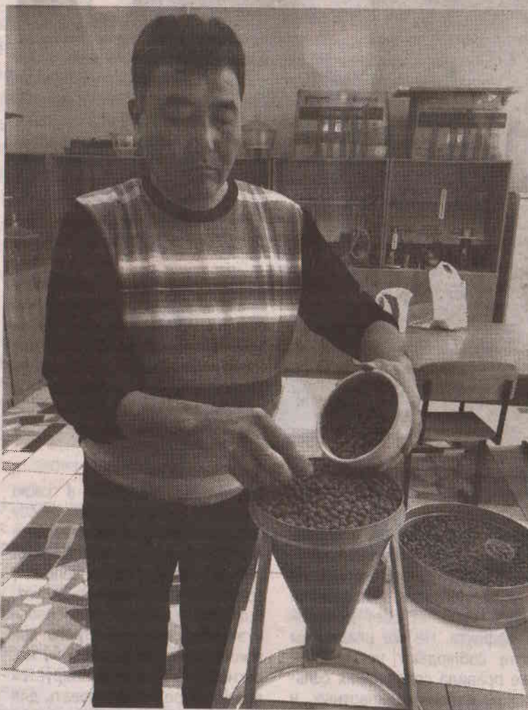
Процесс заполнения упрощенного стенда сорбентами на основе кремнистой породы – опоки, монтмориллонитовой глины и углерода
