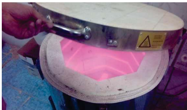
Рисунок 2 – Оборудование в виде мини-печи для технологии фьюзинг
