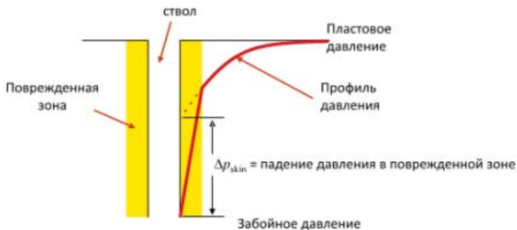
Рисунок 1 – Влияние скин-эффекта на падение давления в ПЗП
