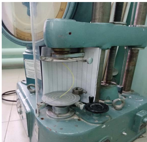
Рисунок 3. Устройства для исследования продольного сжатия стержней.
