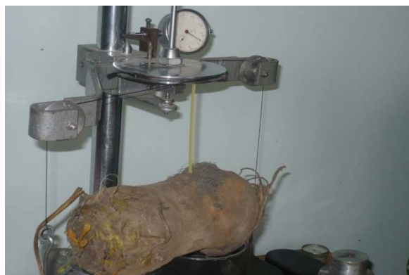
Рисунок 4. Прибор для определения усилий сдвига загрязнений.
