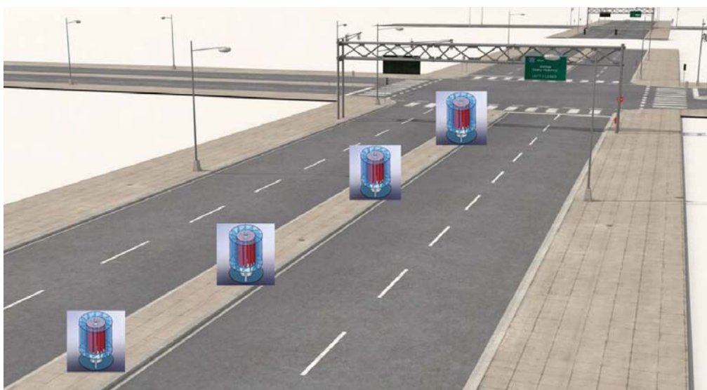
Сурет 2. Көліктер жол жүру жолындағы жел генераторларының тұру концепциясы
