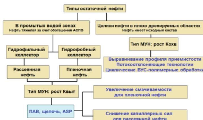
Рисунок 1 – Выбор технологического метода увеличения добычи нефтяного флюида в пластовой системе остаточных запасов нефти
