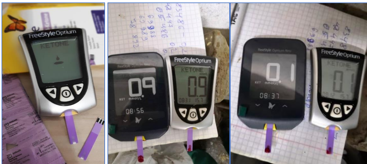
1- сурет - Қанда ВНВ концентрациясын өлшеуге арналған FreeStyle (Abbot Diabetes Care, USA) сериясының электрондық аспаптары
