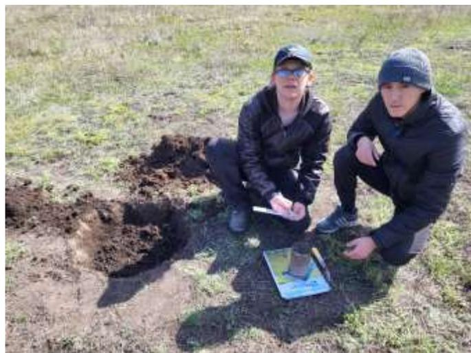
Рисунок 3 – Определение плотности почвы в условиях пастбищ
