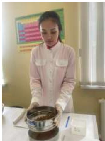
Сурет 4 – Құрғақтай елеу арқылы топырақ құрылымын анықтау
