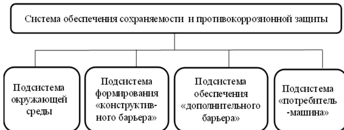
Рисунок 1 – Система обеспечения сохраняемости и противокоррозионной защиты
